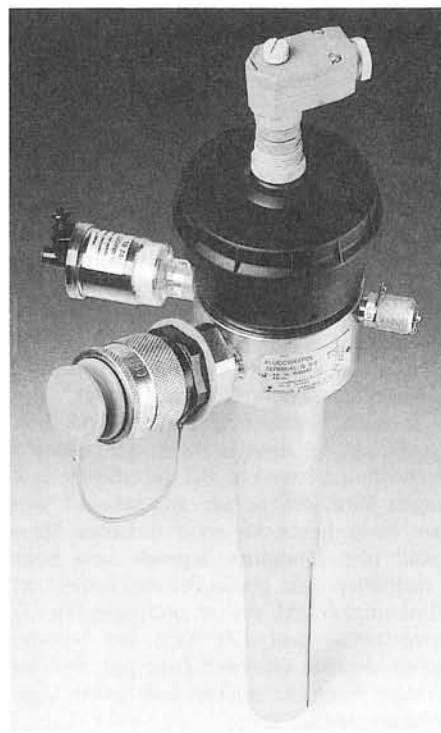
2: An Stelle des vorhandenen Belüftungsfilters eingebaut, ermöglicht dieses Gerät die aktive Leckageüberwachung und bietet außerdem die Möglichkeit der Temperaturüberwachung, einen Befüllanschluß sowie eine Probenabnahmekupplung
