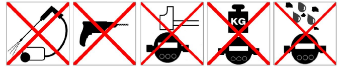
Abb. 4: Unzulässige mechanische Beanspruchung
