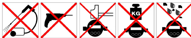
Fig. 4: Contraintes mécaniques interdites
