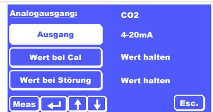
Die Skalierung des Analogausgangs hängt von den Einstellungen der Messbereiche MB1 bzw. MB2 ab. Der untere Wert von MB1 ist identisch mit dem des MB2 und entspricht dabei dem unteren Analogwert. Der obere Analogwert entspricht dem Endwert des jeweils aktiven Messbereichs. Beachten Sie, dass sich bei automatischer Umschaltung des Messbereiches der Endwert auch automatisch anpasst. Dies ist bei Auswertung des Analogsignals zwingend zu berücksichtigen.
