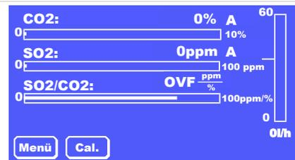
Warten Sie eine Aufwärmphase von mindestens **30 Minuten** ab und führen Sie danach eine erste Kalibrierung durch. Wenn Sie sehr geringe Konzentrationen messen wollen, kann es sinnvoll sein, das Gerät weiter **bis zu 3 h** aufwärmen zu lassen.
